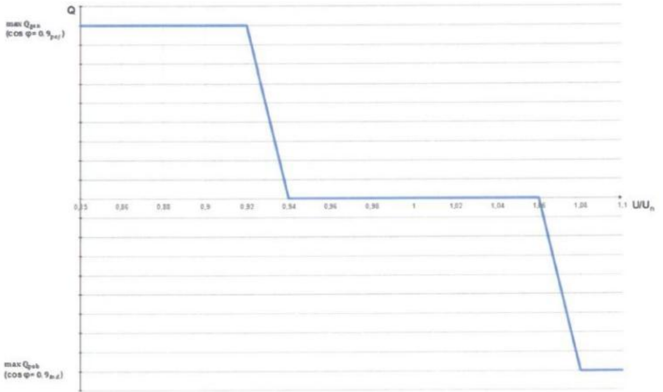
Rys.3. Charakterystyka sterowania mocą bierną w funkcji napięcia wymagana przez OSDn.
